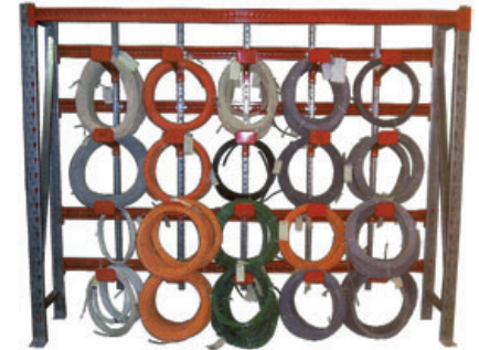
Estantería para cables. Ref. 12110 Con 12 brazos de tubo cuadrado de 40 / 430 mm. Medidas: Ancho 1.800, fondo 550, alto 2.300 mm. Carga: 80 kg por brazo
